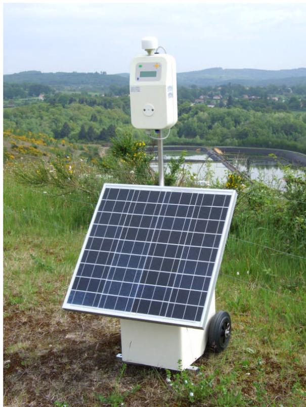
□ Dispositif d'alimentation par panneau solaire conçu pour l'alimentation en continu d'appareils de prélèvement ou de mesure.
